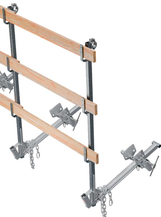
Der **Dachfang Quick Plus** ist die ideale Brüstung zur Sicherung der Trauflinie bei Holzdächern. Die Demontage macht das Produkt noch vorteilhafter im Vergleich zu anderen, denn dank eines Hebels können die Klemmen mit einem einzigen Hub geöffnet und gelöst werden. Das Geländer ist über eine Kette mit den Klammern verbunden, so dass sich die beiden Teile bei der Montage und Demontage nicht versehentlich lösen können.
