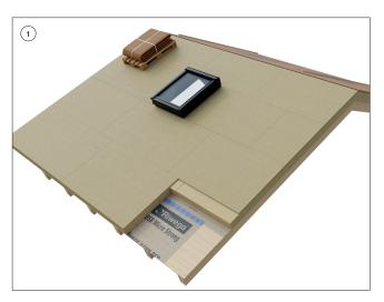
Posizionare il pallet contenente la membrana ripiegata in alto sulla falda da ricoprire
