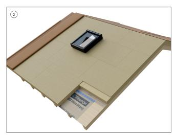
Srotolare la membrana iniziando in senso verticale e fissare il primo contro-listello sul bordo della falda
