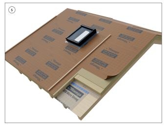
Una vez extendida la membrana sobre el faldón de la cubierta sin que presente pliegues, fijarla con un segundo contrarrastrel
