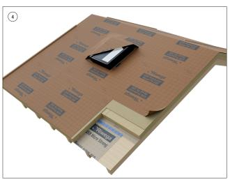
Cortar la membrana y sellarla alrededor de los cuerpos que emergen del faldón de la cubierta mediante los accesorios
