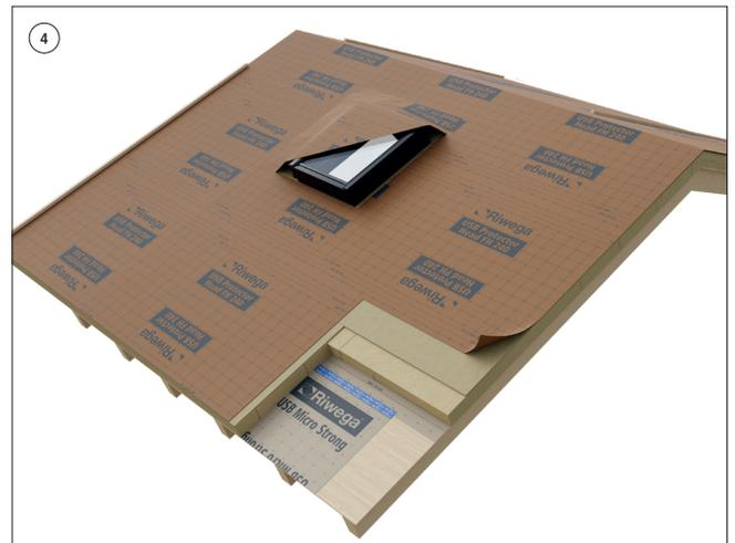
Schneiden Sie die Membrane zu und dichten Sie diese um die Öffnungen mit dem richtigem Klebzubehör ab
