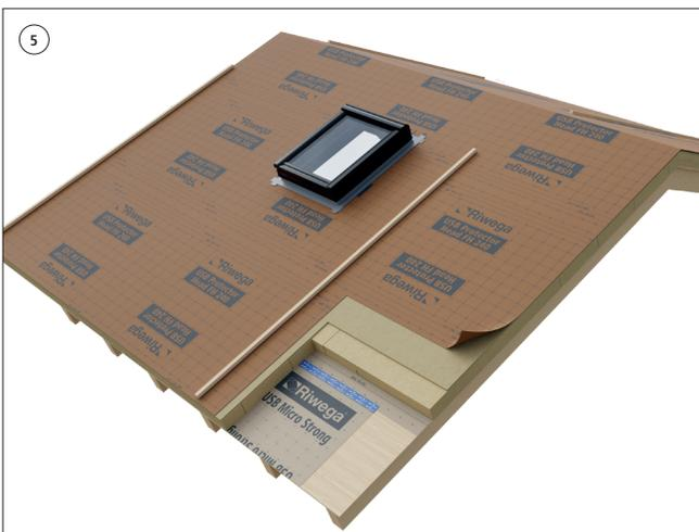
Die Membran auf die Dachfläche faltenfrei verlegen und sie mit einer zweiten Konterlatte fixieren
