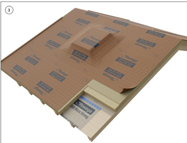
Nach Montage der ersten Konterlatte, breiten Sie die Membrane vollflächig horizontal über die Dachfläche aus
